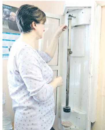
В экстренных случаях метеоданные собираются вручную. На фото ртутный барометр 1960-х годов. Его показания до сих пор отличаются высокой точностью.
