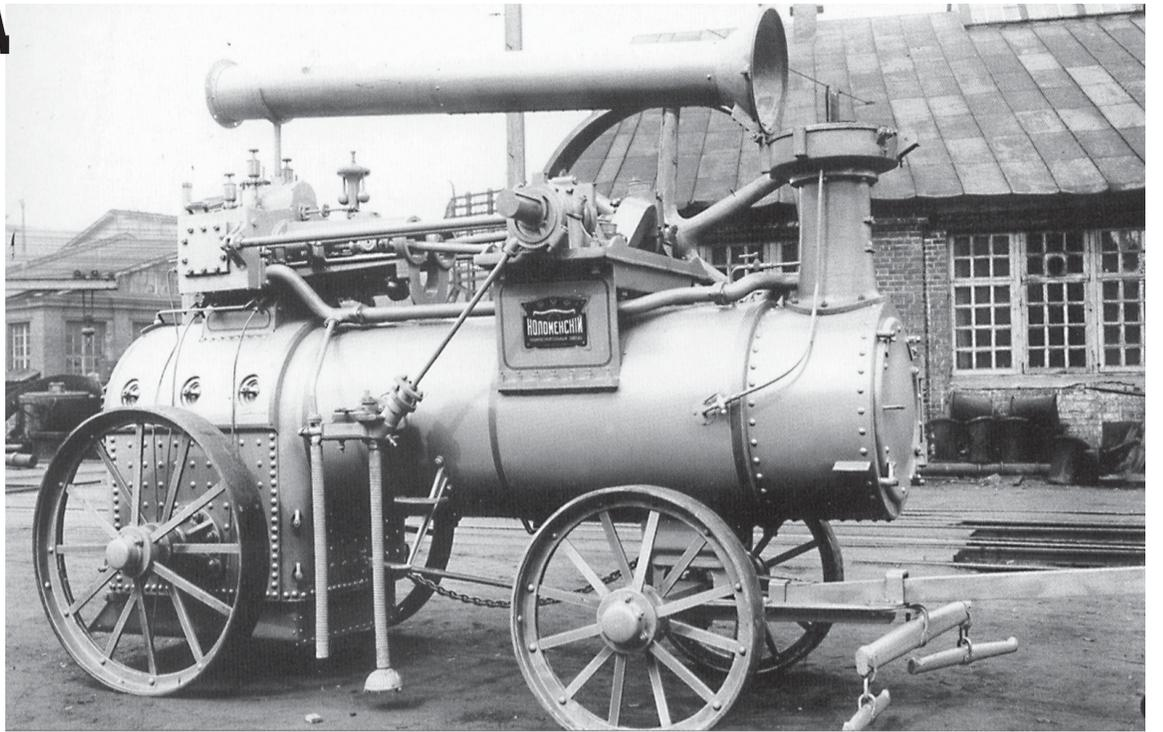
**ЛОКОМОБИЛЬ** — компактный передвижной паровой двигатель для привода неподвижных с/х машин, насосов, электрогенераторов. Фото конца XIX века.
